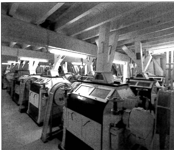
Sint-Amands aan de Schelde, Maalderij Scheldemolens, maalzaal met cilindermolens; 'Seck' (1910) en 'Bühler' (1939) – Documentatiecentrum voor Molinologie, Sint-Amands
